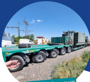
Anlieferung des neuen Transformators
