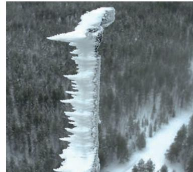
*Windfahne am Messmast im finnischen wpd Projekt Nuolivaara: Anhand der Kamerabilder wird auch der Grad der Vereisung überwacht*
