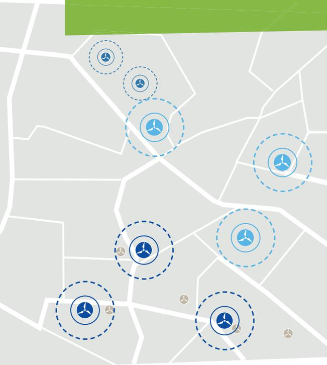
*Das Konzept für den Weiterbetrieb des Altwindparks: 2 Anlagen bleiben bestehen, 3 neue Anlagen ersetzen 5 Altanlagen und 3 Anlagen erweitern den Windpark*
