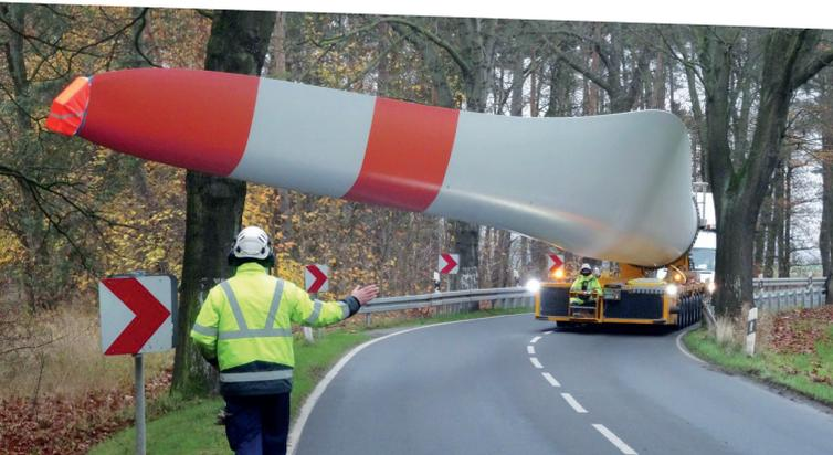
*Mit dem Bladelifter ist der Transport der Rotorblätter auch in engen Kurven möglich*
